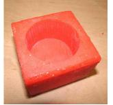
Zum entformen nun die Schraube lösen, danach lässt sich der Block einfach entnehmen. Jetzt einfach von unten das runde Teil herausdrücken, fertig.
