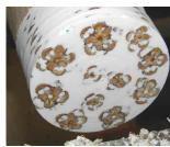
Nach dem Entformen des Blocks wird dieser auf eine runde Kantel geklebt und nach durchhärten des Klebers vorne abgedreht.
