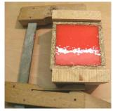
Die beiden kleineren Seitenteile werden nun mit der Grundplatte verklebt, die beiden anderen Teile mittels Schraubzwinge rangepresst und dann alles innen mit Silikonspray besprüht. Danach die Form mit Formengießmasse D&M SAM1 ausfüllen.
