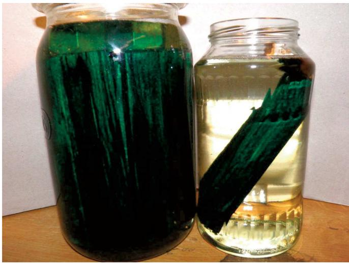
Nachdem die Blanks ein paar Tage getrocknet sind können sie stabilisiert werden. Einen Blank habe ich in ungefärbtes Stabi gegeben, die anderen sind in gefärbtem Stabi untergebracht.
