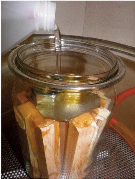
Geben Sie die Blanks in ein Glas, Beschwerung obendrauf und mit Harz auffüllen bis über die Blanks. Vergessen Sie nicht noch etwas Platz zu lassen für den Schaum.
