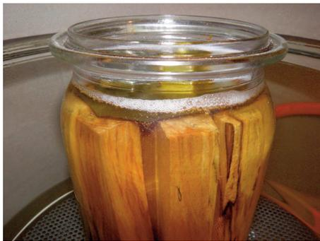
So ist das Glas korrekt gefüllt, die ersten Luftblasen verlassen freiwillig das Holz, noch ohne Vakuum.
