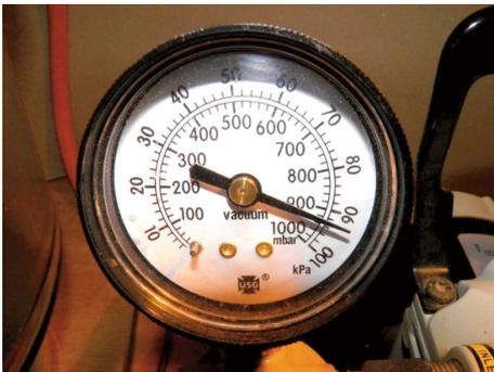
Das Ende ist erreicht, 940 mB, etwas mehr als nach Herstellerangabe (920 mB) der Vakuumpumpe erreicht werden kann.
